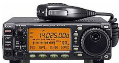
КВ трансивер IC-703
